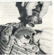
PHOTO 48 : Installation du pignon et de l'arbre à cames ; la flèche désigne le trou de positionnement (Photo RMT)
