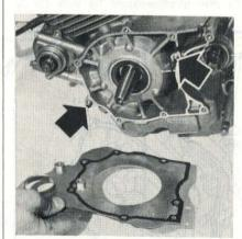
PHOTO 35 : Les deux douilles de centrage du flasque gauche (Photo RMT)
