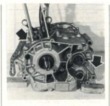
PHOTO 56 : Les deux vis côté gauche du carter-moteur (Photo RMT)
