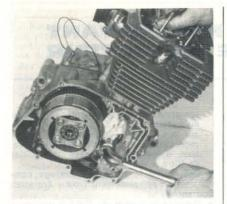
PHOTO 41 : Méthode de blocage de la transmission primaire avec un chiffon plié plusieurs fois entre les pignons (Photo RMT)
