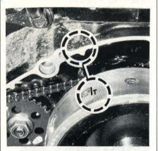
PHOTO 46: Pour mettre le piston au P.M.H., aligner le trait du repère « T » avec cette pointe de carter (Photo RMT)
