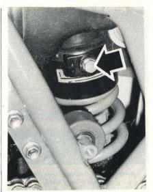
PHOTO 27 : Vis de réglage de dureté d'amortisseur arrière (Photo RMT)
