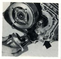
PHOTO 39 : Le petit joint torique à ne pas oublier avant de reposer la pompe à huile (Photo RMT)
