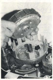
PHOTO 57 : Repose de l'ensemble noix-disques-plateau de pression (Photo RMT)
