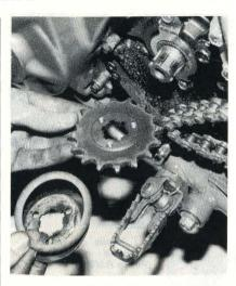
PHOTO 22 : La face épaulée du pignon va côté moteur (Photo RMT)
