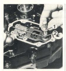
PHOTO 61 : Mécanisme de sélection 1. Rondelle - 2. Circlip (Photo RMT)
