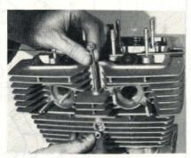
PHOTO 50 : Prendre garde de ne pas perdre l'écrou en enlevant la vis avant de Ø 6 mm de la culasse (Photo RMT)
