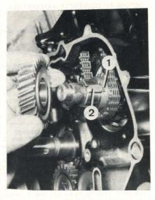
PHOTO 59 : 1. Clavette coudée - 2. Clavette droite (Photo RMT)
