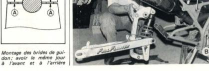
PHOTO 82 : Dépose de la suspension arrière A. et B. désignent les deux axes à retirer (Photo RMT)
