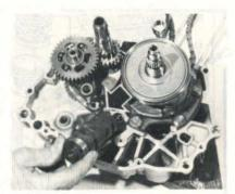
PHOTO 62: Repose du tambour avec son ergot (flèche) contre le contacteur de point mort (Photo RMT)
