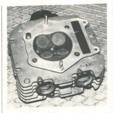
Quatre soupapes, deux bougies, chambre de combustion à double dôme, voici les particularités de la culasse de la DR 600 S (Photo RMT)
