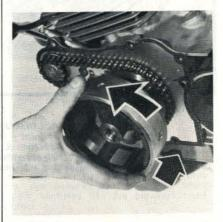
PHOTO 33 : Repose du rotor d'alternateur CM 125 C en le tournant tout en le poussant (Photo RMT)
