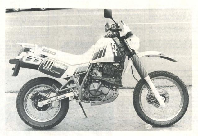
La DR 600 « Djebel » version 89 reçoit un frein à disque à commande hydraulique sur la roue arrière. (Photo RMT)
