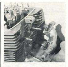
PHOTO 53 : La pipe d'admission est équipée de deux joints toriques (Photo RMT)
