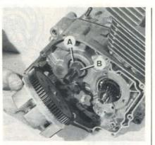
PHOTO 43 : Remontage de l'ensemble cloche-couronne primaire sur moteur CM 125 C A. Rondelle - B. Bague entretoise (Photo RMT)
