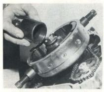
PHOTO 63 : Installation de l'extracteur de rotor (Photo RMT)
