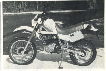
La partie arrière se caractérise bien sûr par la suspension « Full Floater », mais également par l'ancrage de frein arrière type parallélogramme et par les repose-pieds suspendus (Photo RMT)
