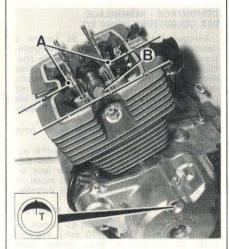
PHOTO 29 : Calage de la distribution A. Coups de pointeau du pignon -B. Encoche en bout d'arbre à cames (Photo RMT)
