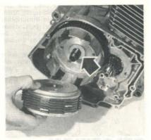
PHOTO 44 : Rondelle crénelée au fond de la cloche (Photo RMT)
