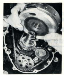
PHOTO 64 : Clavette du rotor d'alternateur (Photo RMT)
