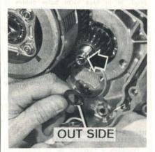
PHOTO 46 : Avant de remettre la rondelle conique et l'écrou, s'assurer de la présence du petit axe diamétral à l'extrémité de la queue du vilebrequin (Photo RMT)
