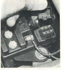
PHOTO 20 : Fusible de protection et fusible de rechange (Photo RMT)
