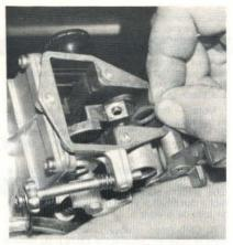
PHOTO 39 : Rondelle nylon de l'axe de commande des gaz (Photo RMT)
