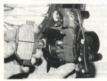
PHOTO 31 : Dépose des plaquettes (Photo RMT)
