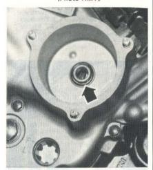
PHOTO 4 : Joint torique au fond du logement de filtre à huile (Photo RMT)
