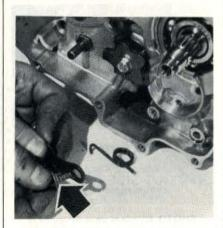
PHOTO 49 : Le doigt de verrouillage doit s'articuler sur l'épaulement de la vis (Photo RMT)
