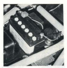
PHOTO 19 : Batterie placée sous la selle (Photo RMT)
