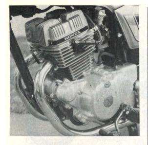
Le moteur des CM 125 CC et CF reprend les carters du CM 250 C, ce qui explique une inclinaison moindre de 5º des cylindres. De plus, l'abandon du kick-starter se justifie par un équipement électrique en 12 V plus puissant (Photo RMT)
