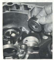
PHOTO 73: Roulement gauche d'arbre primaire dont le côté flasqué va au fond du logement (Photo RMT)
