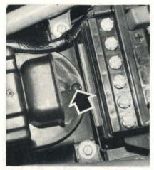
PHOTO 5 : Vis du couvercle de filtre à air (Photo RMT)
