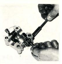
PHOTO 27 : Extraction d'un axe de culbuteur avec une vis de Ø 5 mm (Photo RMT)
