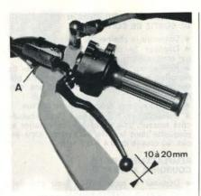
PHOTO 17 : Garde au levier d'embrayage et tendeur (A) (Photo RMT)
