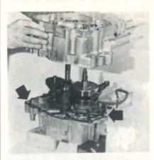
PHOTO 58 : Les deux douilles de centrage des deux demi-carters (Photo RMT)
