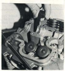
PHOTO 45 : Mettre le patin en biais pour le sortir (Photo RMT)
