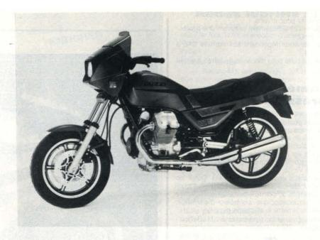
La nouvelle Moto-Guzzi V 75 est dotée d'un moteur à culasses 4 soupapes extrapolé du V 65 Lario. L'augmentation de cylindrée est obtenue par allongement de la course qui passe de 64 à 74 mm, l'alésage falsant toujours 80 mm. La puissance et le couple annoncés sont respectivement de 61 ch à 7100 tr/mn et 6,26 kg.m à 5600 tr/mn. Grâce à un poids de seulement 175 kg, ces valeurs assez faibles dans l'absolu devraient conférer d'honnêtes performances à cette moto.
