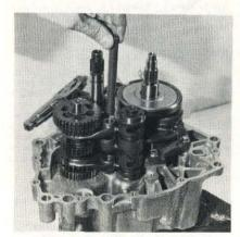
PHOTO 59 : Extraction de l'axe des fourchettes (Photo RMT)
