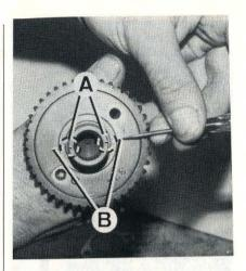
PHOTO 47 : A. Repères en bout d'arbre à cames - B. Repères à tracer sur le pignon (Photo RMT)
