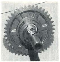
PHOTOS 75 et 76 : Repères à aligner au réassemblage du mécanisme de kick (Photos RMT)
