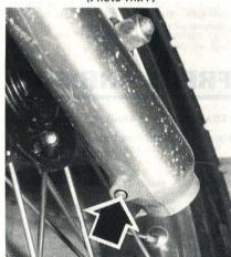
PHOTO 25 : Vis de vidange de fourche (Photo RMT)
