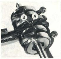
PHOTO 64 : Dépose du patin de tension A. Goupille Beta - B. Rondelle (Photo RMT)
