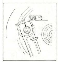
CONTROLE D'USURE DE FREIN ARRIERE En appuyant sur la pédale de frein, la fente de la biellette ne doit pas
