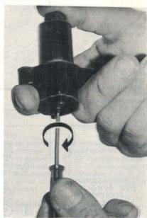
PHOTO 52 : Enfoncer le poussoir tout en tournant la pièce interne au tendeur (Photo RMT)
