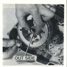
PHOTO 45 : Sens de montage de la rondelle conique de l'arbre primaire (Photo RMT)
